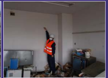
壁面の痕跡から浸水深を計測
