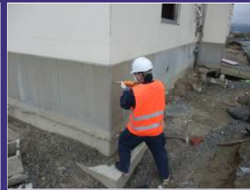
被災建築物の材料強度を測定
