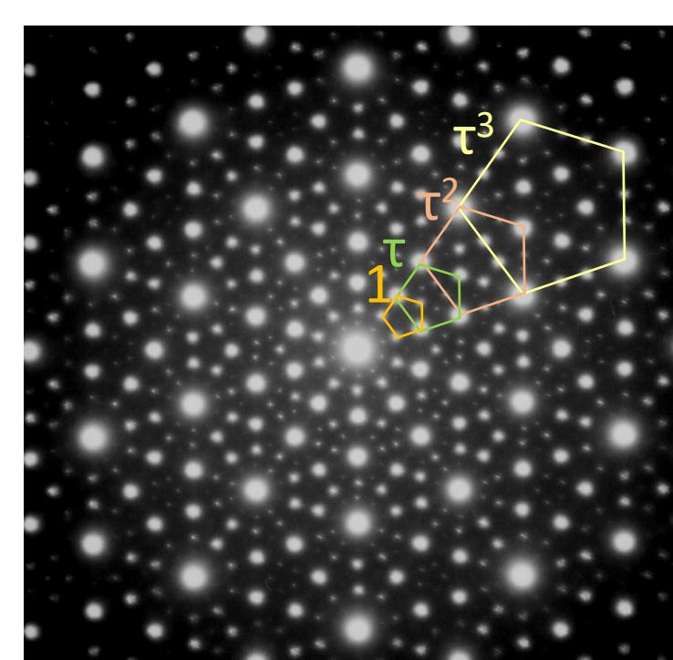
Al-Cu-Fe系正20面体準結晶の高温比熱における5回軸入射の電子線回折図形
